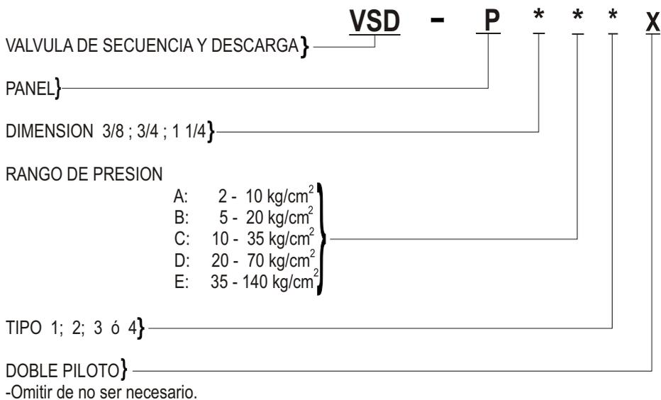
La regulación de presión de los distintos tipos de válvulas de secuencia y descarga debe ser inferior en 15 - 20% a los regulados en las válvulas de máxima presión.
