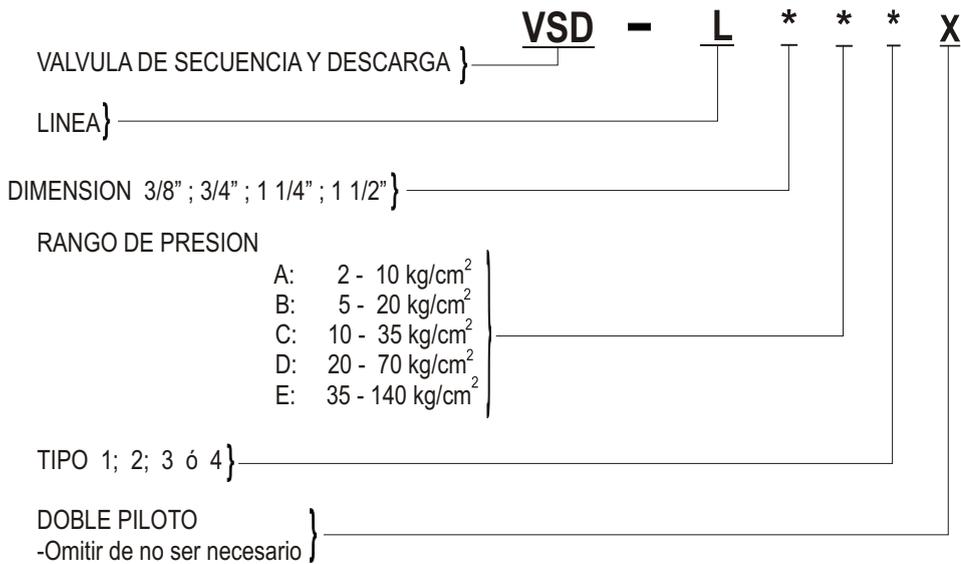
La regulación de presión de los distintos tipos de válvulas de secuencia y descarga debe ser inferior en 15 - 20% a los regulados en las válvulas de máxima presión.
