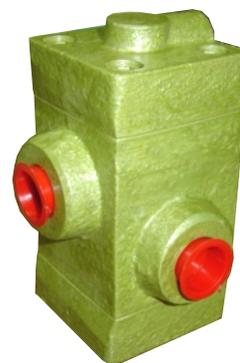
La válvula de retención pilotada línea (VRTPL - L) se intercala directamente en la tubería. Cumple la función de válvula unidireccional comandada. El fluido pasa libre en un sentido venciendo un resorte, no permitiendo el retorno en el sentido inverso. Para retornar en sentido inverso, se debe comandar por medio de una señal piloto, externa a la válvula.
