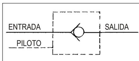
Se fabrican dos sistemas distintos dentro de cada tamaño; piloto de acción directa o con descompresor.
