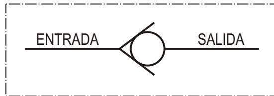
**APLICACION:** Se utiliza como válvula unidireccional separando bombas en circuitos de alta y baja o en la independización de circuitos.
